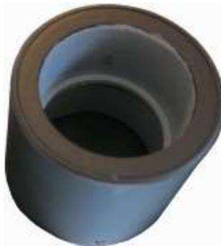
Elle est réalisée avec 3 éléments PVC de plomberie (1 manchon de 80 et 2 tampons 80/63)
