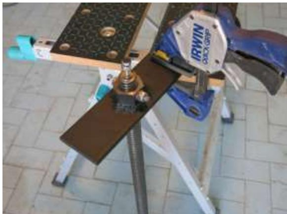
Fixation de l'enclume sur la vis trapézoïdale
