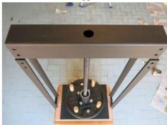
Vissage de la poutre haute sur quelques pas
